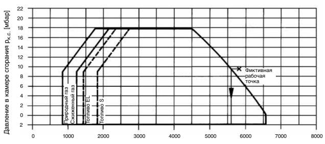
Тепловая мощность горелки Q<sub>г</sub> [кВт]
