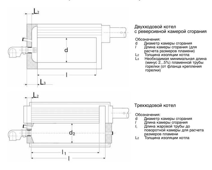
Для экономного сжигания топлива, получения высокого КПД и хороших показателей эмиссии необходимо правильно подбирать горелки к тепловым установкам.
